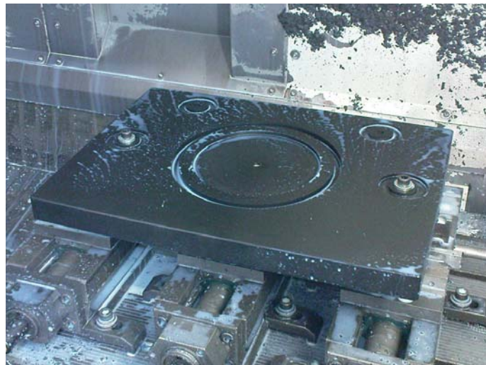
Perfekt und reproduzierbar: CNC-Fertigung des CORIAN-Chassis
