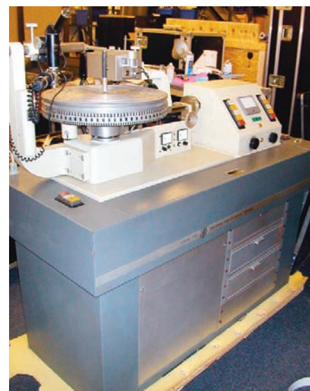
Neumann VMS70 Gesamtansicht mit Steuerpult und angeschlossener Heliumkühlung
